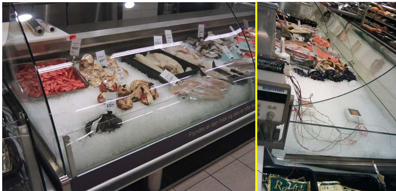
Figur 26. Moderne ”lukket” fiskedisk med mekanisk kjøling og viftesirkulasjon. Figur til venstre: under vanlig salg; figur til høyre: plassering av varmefluksinstrumentene.
